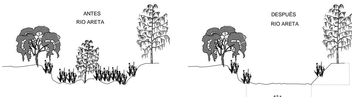
ACTUACIÓN 1: LIMPIEZA DE CAUCES
